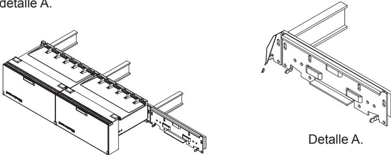
*\*El Soporte de montaje ya contiene huecos universales para la instalacion. Puede ser usado en diferentes bastidores no ilustrado en este dibujo.*
