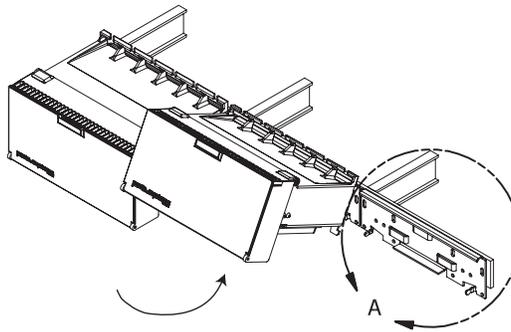
**Step 3:** Rotela hacia abajo buscando alinear las ranuras inferiores de la pieza con las cejillas del soporte hasta alcanzar una posicion recta.
